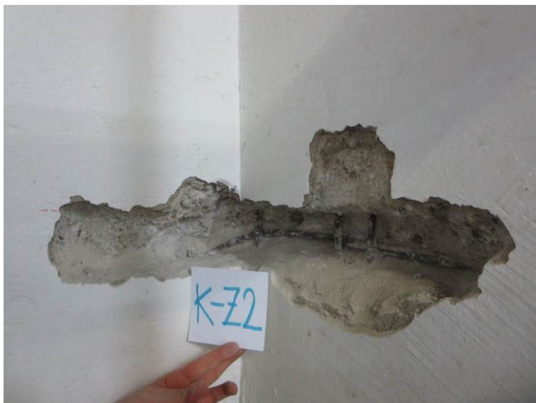
Slika 41: Preiskovalna sonda K-Z2 na zidu v kleti, notranja stena: nearmiran beton, zunanja stena: armiran beton
