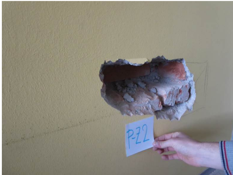
Slika 49: Preiskovalna sonda P-Z2 na zidu v pritličju: opečni zid, odvzem vzorca opeke
