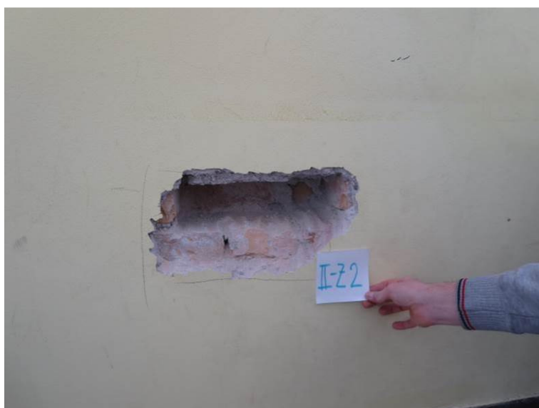
Slika 57: Preiskovalna sonda II-Z2 na zidu v II. nadstropju: opečni zid, odvzem vzorca opeke
